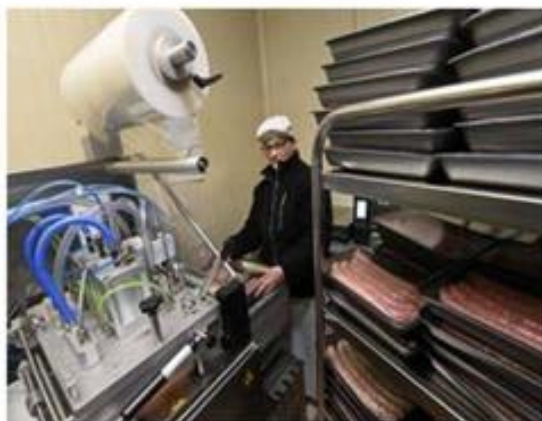
Édith travaille sur la nouvelle machine de mise sous atmosphère qui permet d'emballer les saucisses. Photo F.L.
